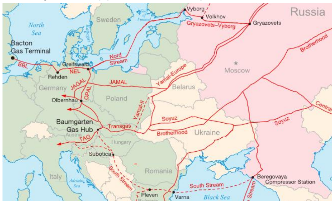
Abbildung 21 Transitpipelinenetz in Osteuropa
